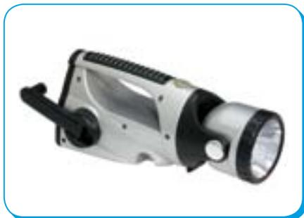
Rigel si pone al vertice della gamma grazie alla sua versatilità e potenza: 5 LED ultraluminosi da 10mm su una piattaforma con caratteristiche estremamente innovative. Testa rotante a 180°, base magnetica, impugnatura fosforescente e pratico indicatore di ricarica e accumulatore pieno. Il selettore consente di scegliere tra l'accensione di 3 o tutti e 5 i led.
