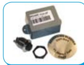
Disattivatore per allarme retromarcia utilizzato nei paesi con normativa di riduzione acustica. Relè temporizzato a pressione singola montato su cruscotto. Consente al conducente di escludere il dispositivo BACKALARM se si effettuano manovre di retromarcia su strade extraurbane in orari compresi tra le 11.30 pm - 7.30 am. Il sistema effettua il reset automatico dopo un intervallo di 3-4 minuti.
