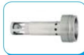
Dispositivo in alluminio utile per prevenire il furto del gasolio. Testato fino a 120 lt/minuto, non ostacola le normali operazioni di rifornimento. Dotato di una apposita valvola, non permette di aspirare carburante, anche quando il serbatoio è colmo, ed evita l'uscita del carburante in eccesso.
